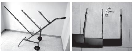
3.- Localizar las tres cuchillas dentadas y las seis palometas de sujeción de las mismas.
