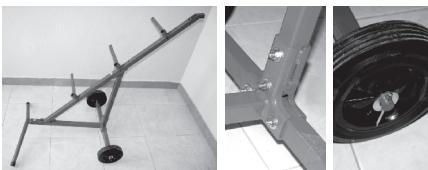
2.- Con la estructura una vez asegurada y estable, se puede proceder a montar el resto de partes; roscar el asa y colocarle el manguito con ayuda de un poco de alcohol, montar el soporte de cintas y asegurar con arandela + tuerca, colocar las barras diagonales y asegurarlas con un tornillo cada una. Es importante en este punto verificar la perfecta estabilidad del conjunto y apriete de todas las tuercas.
