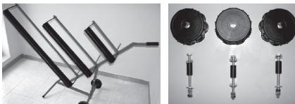
5.- Las ruletas portacinta se montan mediante los tres tornillos extralargos suministrados, con dos arandelas, y un cojinete plástico, asegurándolos mediante dos tuercas cada uno. Una vez fijadas en su lugar verificar que giran libremente.
